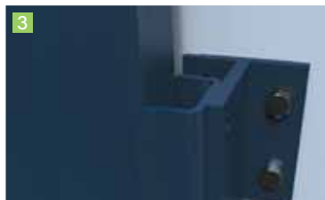
3 U de réception avec système « anti-dégondage » (pour éviter le soulèvement du portail en position fermée) fourni de la couleur du portail.
